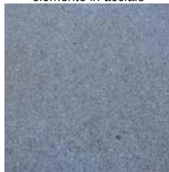
Pavimentazione in calcestruzzo architettonico colorato ghiaia a vista
